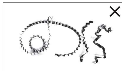
Продолительно спиральная длинная стружка
