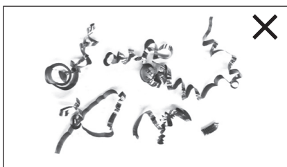
Стружка в форме чищенной кожуры яблока (без загибания)
