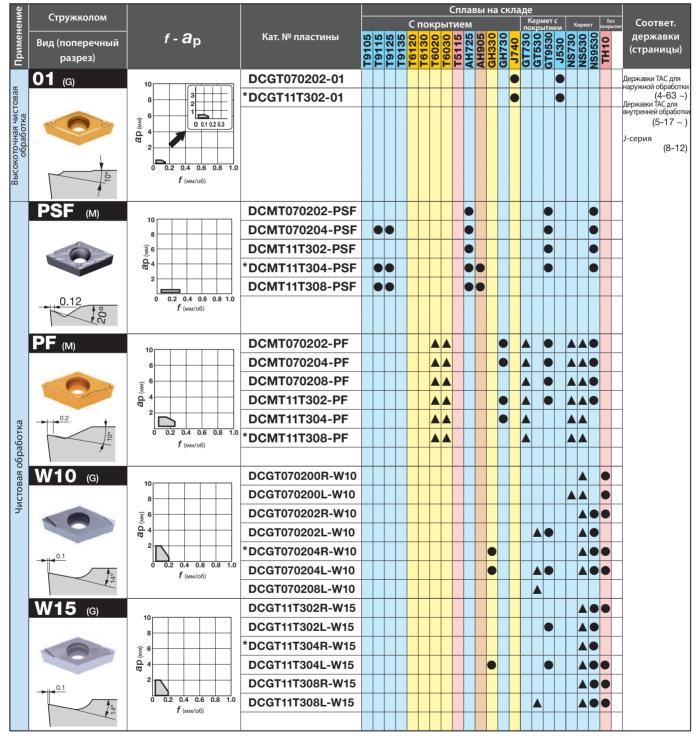
Примечание: поперечные разрезы стружколомов представлены для пластин, отмеченных звездочкой  $^*$ .
