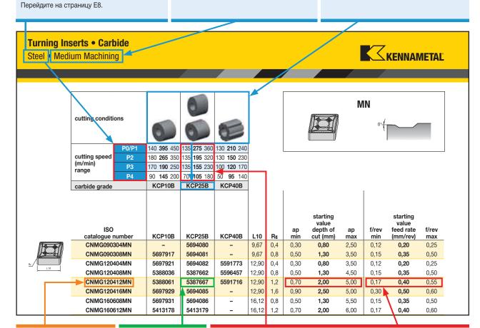
Выберите пластину требуемого типа и размера с нужным радиусом скругления.
