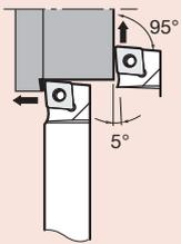
Исполнение режущей кромки **L2**
