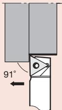
Исполнение режущей кромки **A**
