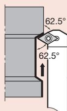
Исполнение режущей кромки **N3**
