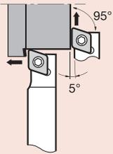
Исполнение режущей кромки **L2**
