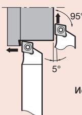
Исполнение режущей кромки **L2**
