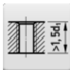
ТИП ОТВЕРСТИЯ Сквозное отверстие (длина резьбы L > 1,5 \times d1 )
