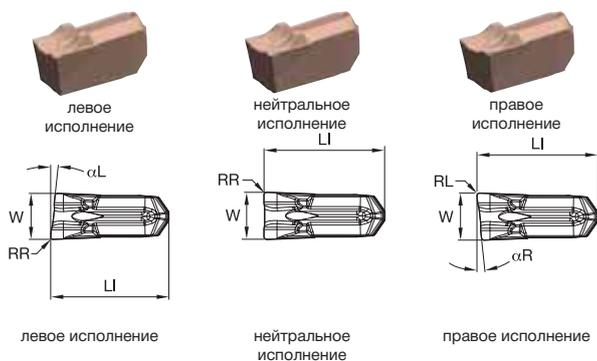
■ Прецизионно спрессованные пластины CR • Метрическая система
