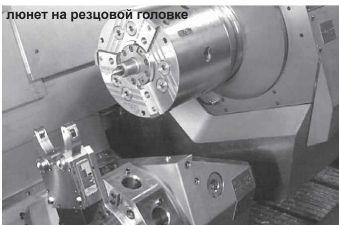
люнет для обработки валов в авиастроении
