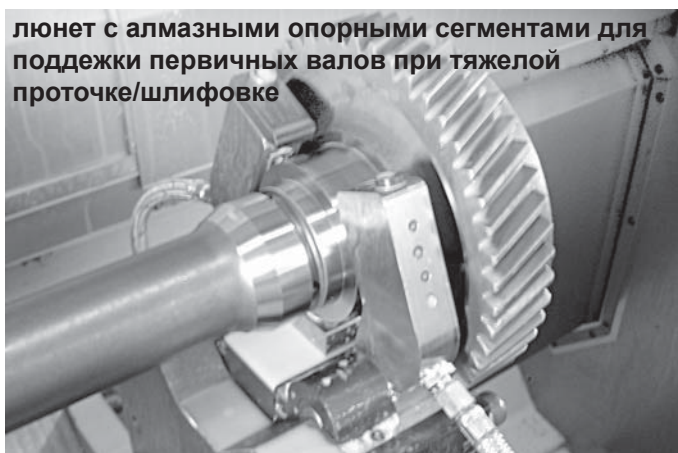
люнет для обработки валов в авиастроении
