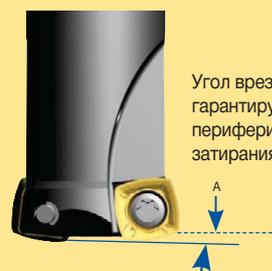
Угол врезания А гарантирует резание только периферийной кромкой без затирания центром фрезы.
